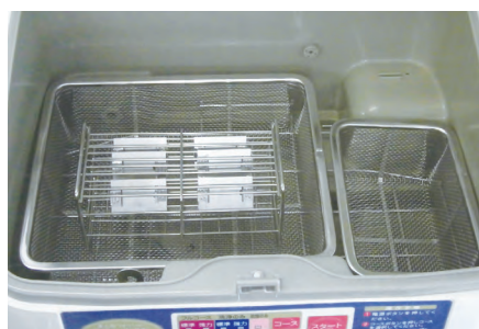
図3 汚染テストピース(非露出部)の設置方法(WD-32)
